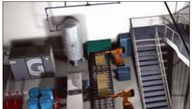
Das GA WorkPlace Luftsystem kann dank seines geräuscharmen Betriebs und der integrierten Luft- und Kondensataufbereitung unmittelbar am Einsatzort aufgestellt werden. Diese Integration spart Platz ein und reduziert die Verrohrungskosten.
