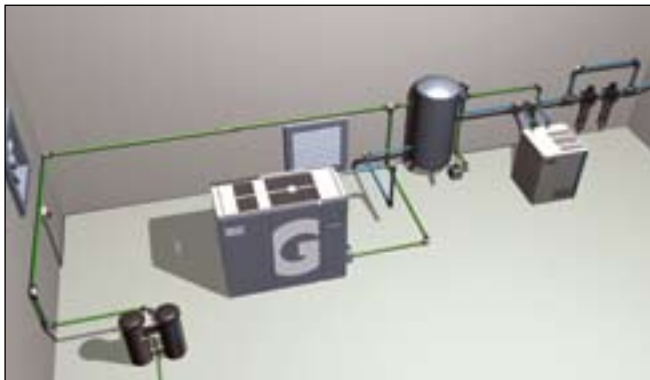
Ein herkömmlicher Kompressor mit externer Filterung und hohem Betriebsgeräuschpegel darf nicht im Produktionsbereich aufgestellt werden. Hierdurch entstehen erhöhte Installationskosten.
